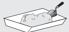
Mezcla preparada para trabajos de pegamento de bloques
