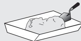
Mezcla preparada para relleno de bastones
